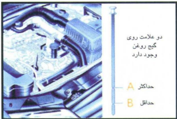
در بعضی از خودروها سطح روغن به صورت اتوماتیک اندازه‌گیری شده و توسط یک نشان‌دهنده بر روی پانل (جلو داشبورد) قابل رؤیت است. در مورد خودروهایی که این نشان‌دهنده را ندارند تعیین سطح روغن توسط گیج انجام می‌گیرد.
